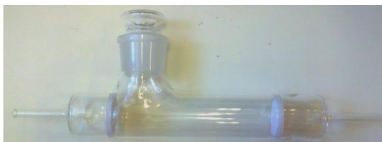
Figura 29 – Tubo de fluxo desenhado e construído para medição de permeabilidade na direção horizontal
