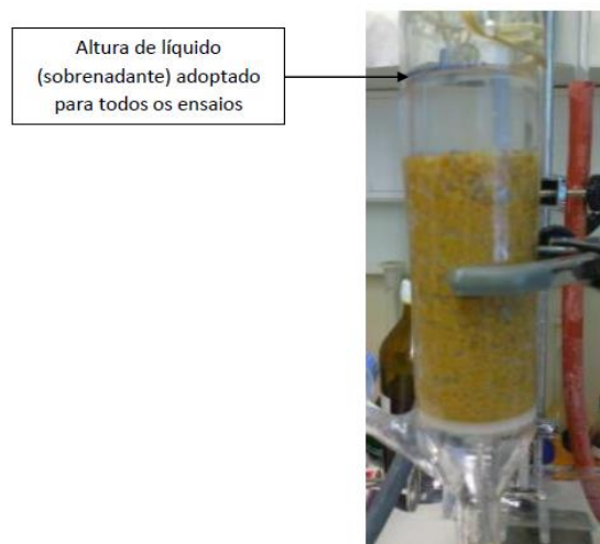
Figura 24 – Sandpack de arenito não consolidado colocado no tubo vertical saturado com água desionizada
