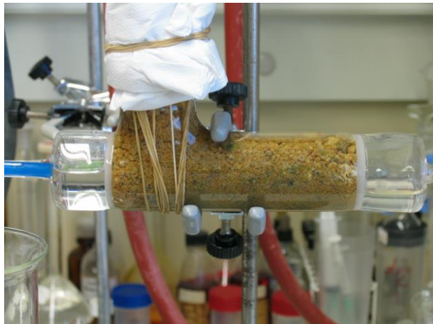
Figura 30 – Tubo de vidro para medição da permeabilidade absoluta na direção horizontal preenchido com sandpack
