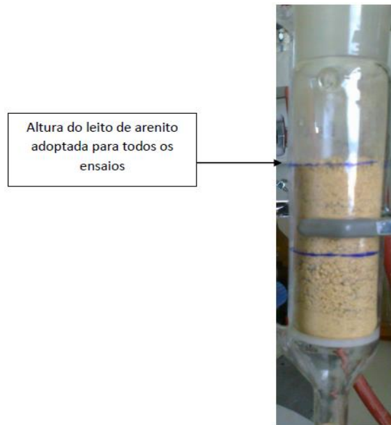
Figura 23 – Sandpack de arenito não consolidado colocado no tubo vertical
