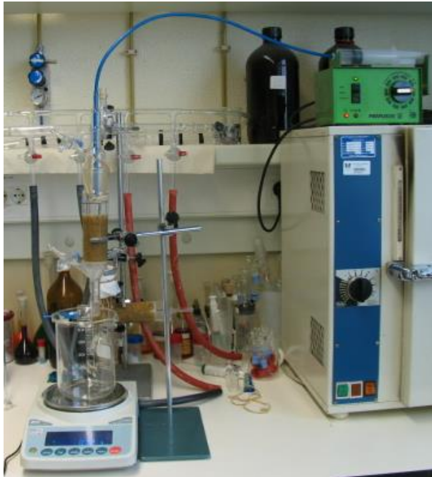
Figura 22 - Montagem experimental para medição da permeabilidade absoluta e efetiva na direção vertical
