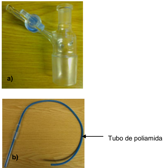
Figura 21 – Tampa de vidro (a) com adaptador para a colocação de um tubo de poliamida no seu interior (b)
